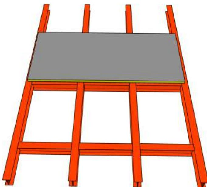
Os painéis devem estar sempre nivelados e alinhados igualmente entre si, respeitando as condições de fixação do parafuso. As juntas entre os painéis devem ser desencontradas/amarradas para permitir maior travamento e estabilidade.
