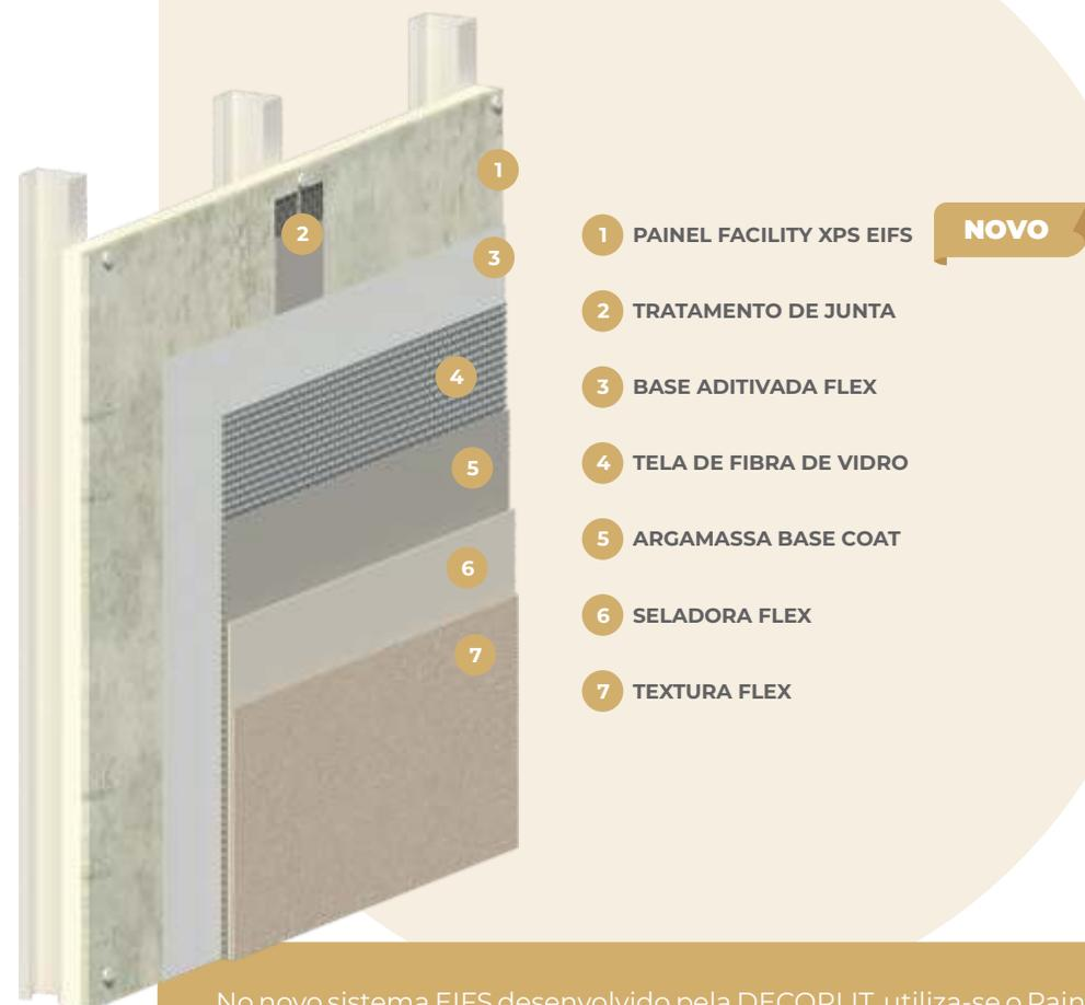
No novo sistema EIFS desenvolvido pela DECORLIT, utiliza-se o Painel Facility XPS como elemento de fechamento com alta performance térmica.
